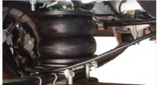
Die VB-SemiAir wird als Zwei-Kammer-System angeboten. Die Luftbälge stehen also nicht in Verbindung miteinander. Die Anwendung eines Zwei-Kammer-Systems hat den Vorteil, dass die Fahrzeughöhe jeweils links und rechts separate eingestellt werden kann.
